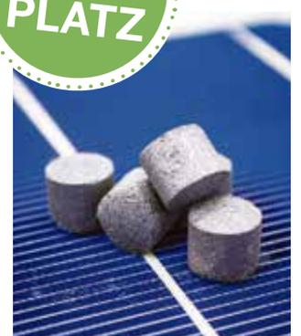
Siliziumpellets auf Solarzelle.
